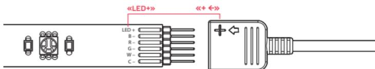
2. Соедините светодиодную ленту с адаптером, как показано на рисунке 2, таким образом, чтобы контакт LED+ на ленте совпал с гнездом «+ ←» на проводе контроллера.
